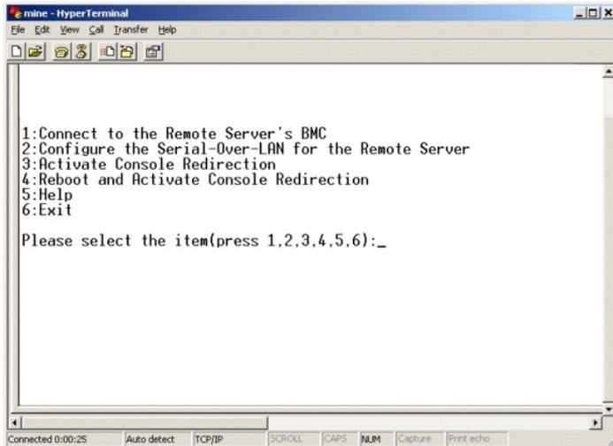
Le menu principal du serveur proxy SOL vous permet de modifier les paramètres SOL du contrôleur BMC d'un système géré distant, de redémarrer le contrôleur BMC distant ou d'activer la redirection de console.
